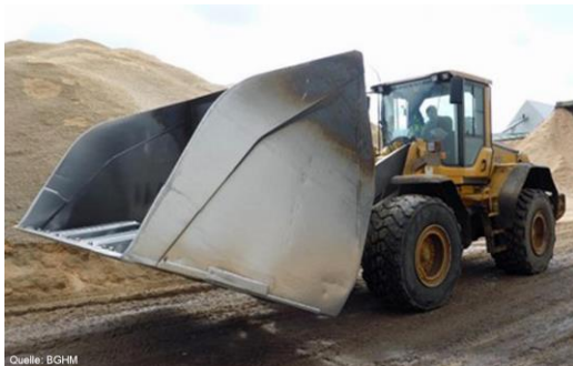
Radlader mit Leichtgutschaufel für 15 m³ Späne
